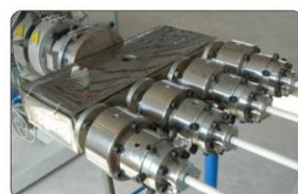
四管挤出 Four output
